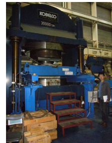
高圧プレス (物材機構)
