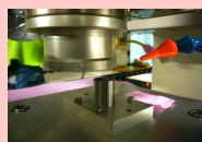
フライカット (1枚刃による回転切削)
